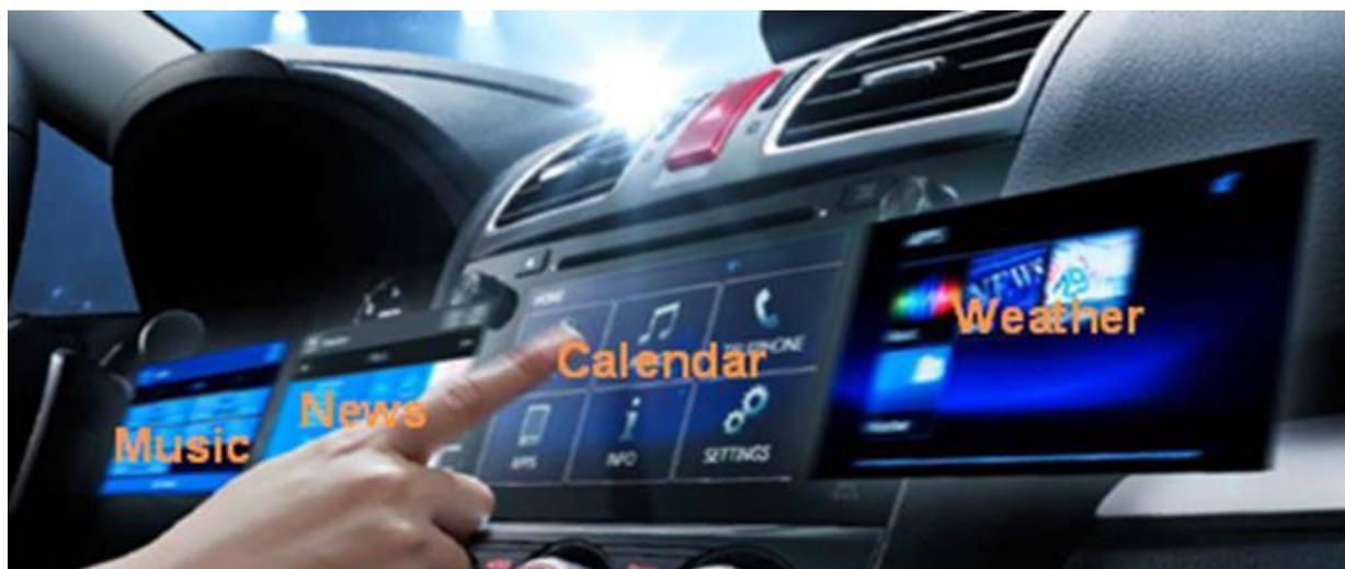
Partendo dalla nuova unità elettronica centrale, che si interfaccia con il guidatore attraverso dei nuovi display centrali a sfioramento in tre possibili varianti. I comandi a sfioramento richiamano quelli noti per gli smartphone: scorrimento, pressione rapida e pressione lunga.
