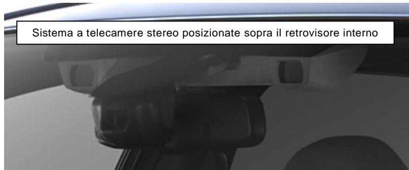
maggio 2008, le funzioni disponibili in questo sistema sono state molto apprezzate. In particolar modo il pre-collision braking system, sistema di controllo della frenata, e l'Adaptive Cruise control, per il monitoraggio continuo su strada e a tutte le velocità.
